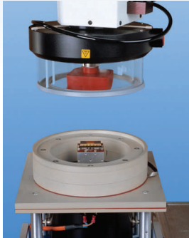
Schwingprüfung von kleinen Baugruppen unter Thermostream®
